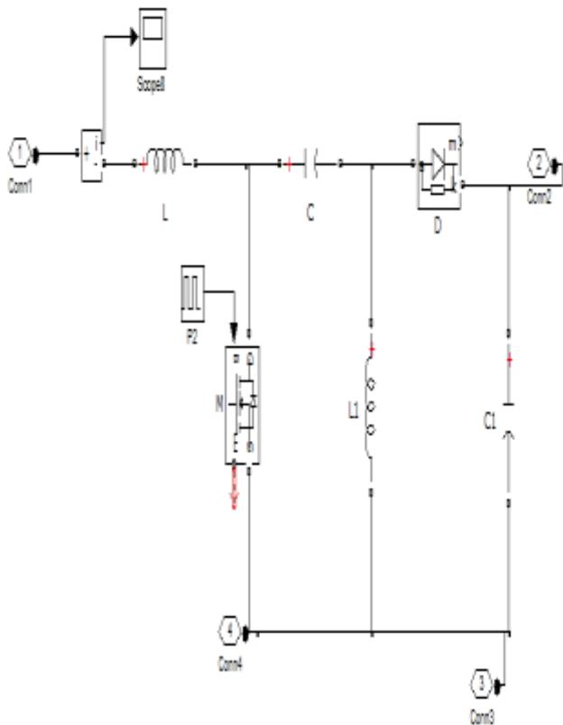
**Fig. 4.6 :**SEPIC converter circuit
